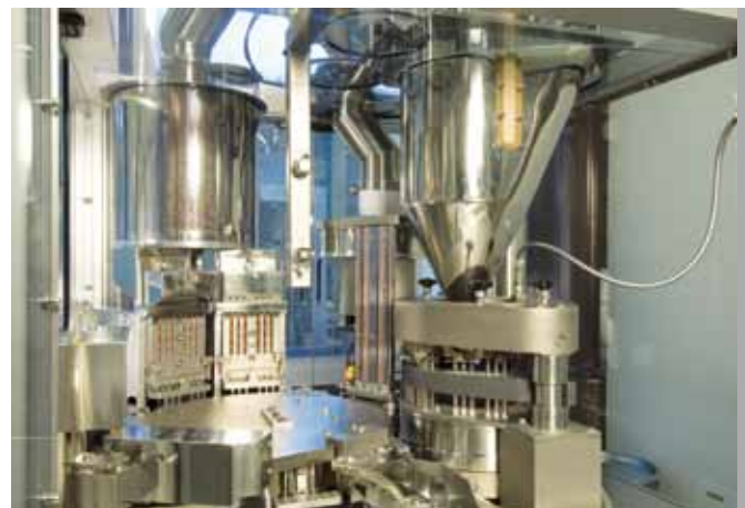
Der Auftragshersteller verfügt über modernste Anlagen zur Tablettenherstellung, hier eine Maschine zur Herstellung von Hartgelatine-Kapseln. Foto: Corden Pharma
