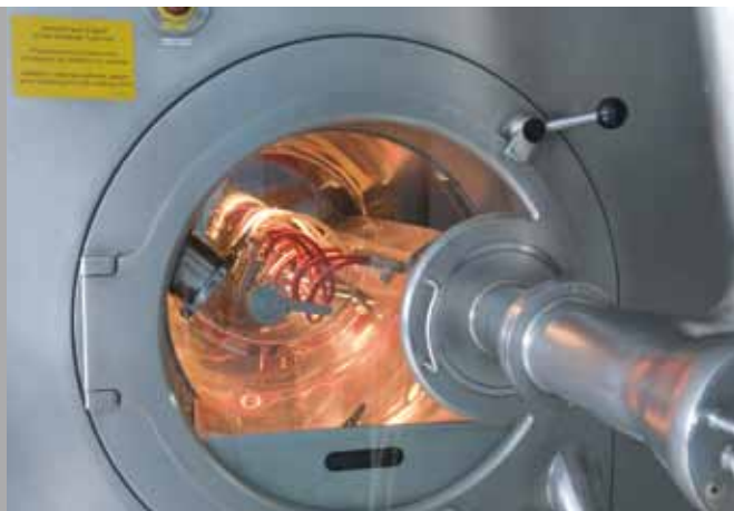
In der hermetisch abgeschlossenen Containment-Anlage lassen sich hochwirksame Substanzen bis zu einem MAK-Wert von 0,001 mg/m 3 zu Tabletten verarbeiten. Foto: Corden Pharma
