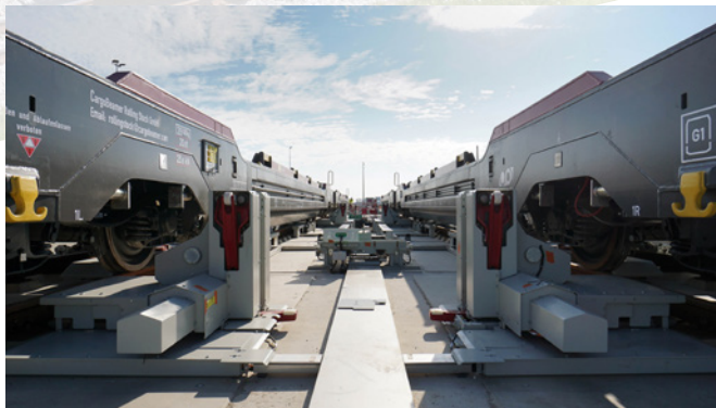
Von CargoBeamer entwickelte, patentierte CargoJet-Waggons mit abklappbaren Seitenwänden ermöglichen das horizontale Be- und Entladen der Auflieger. (© CargoBeamer AG 2023)
