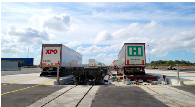
Mit der CargoBeamer-Technologie kann ein ganzer Zug mit bis zu 36 nicht kranbaren Sattelauflegern in unter 20 Minuten be- und entladen werden. (© CargoBeamer AG 2023)
